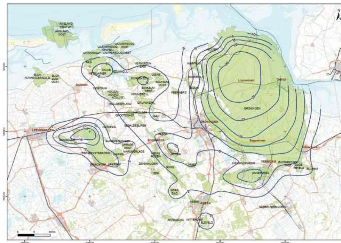
Figuur 2.3 Contourkaart van de bodemdaling door aardgaswinning opgetreden tussen 1964 en 2008. Daling weergegeven in cm
