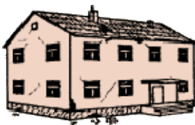
Gradatie 2: Matige schade (lichte constructieve schade)
