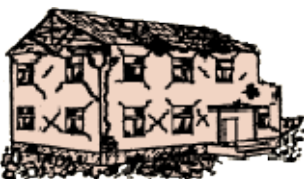
Gradatie 4: Zeer zware schade (zware constructieve schade)
